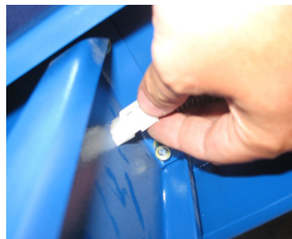
Ilustracja 6: połączenie przewodu zasilającego motoreduktora
