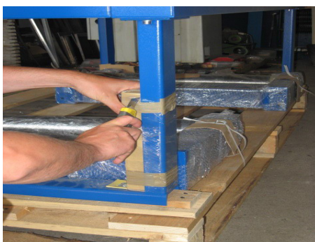
Ilustracja 7: wyjęcie kółek transportowych
