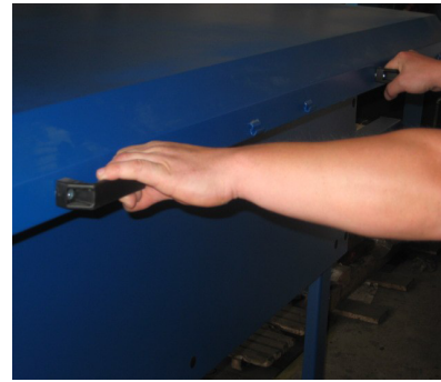
Ilustracja 9: Odslonięcie pokrywy górnej
