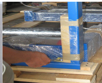
Ilustracja 4: wykręcenie śrub mocujących
