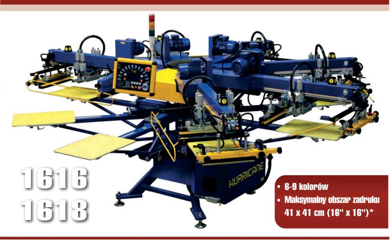
Hurricane jest maszyną powstałą na bazie maszyny Spectrum-S. Zamysłem projektowym było stworzenie maszyny bardzo zwartej o niewielkiej średnicy zewnętrznej, a jednocześnie w pełni wyposażonej. Format zadruku wynosi 41 x 41 cm (opcjonalnie 41 x 46cm). Tak kompaktowa maszyna pozwala uzyskiwać duże prędkości druku (1000 cykli/h), umożliwia instalację na piętrze (wniesienie po schodach).
