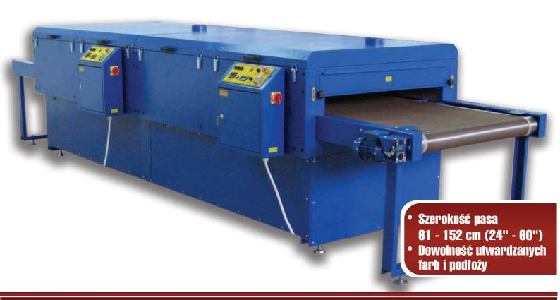
Wielozadaniowe tunele suszące serii DEL oferowane w dostępnych cenach. Segmentowa konstrukcja pozwala na dobór długości komory zgodny z zakładaną przepustowością. Wybór szerokości pasa (24" - 60") określa max. rozmiar elementu suszonego, a także wpływa na przepustowość. Kompaktowe wymiary segmentów ułatwiają transport i instalacje. W razie potrzeby jest możliwość rozłożenia segmentu na części składowe i instalację w trudno dostępnych pomieszczeniach.
