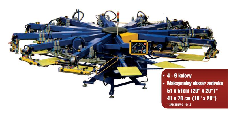
Maszyna Spectrum-S w swoich założeniach pokrywa znaczną część rynku sitodruku w Europie. Oferowana w formacie druku 50 x 55 cm (20 x 22") i rozmiarach od 6 do 12 kolorów. W wersji standardowej znajdziemy servo indexer, elektryczne głowice, system sterowania zapożyczony z flagowej maszyny PRISM. Konstrukcja jest stabilna, dostosowana do przenoszonych obciążeń. Wybór rodzaju mocowania sita: przód-tyl lub boczne, pozwala na dostosowanie do preferencji użytkownika.
